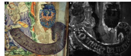
Zobrazení neviditelných a nečitelných informací v iluminovaném rukopise pomocí videospektrálního komparátoru. Foto: Andrei Kazanskii
